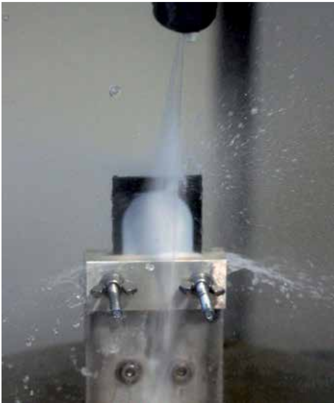
Test avec jet à haute pression répondant à la norme IP69K.
