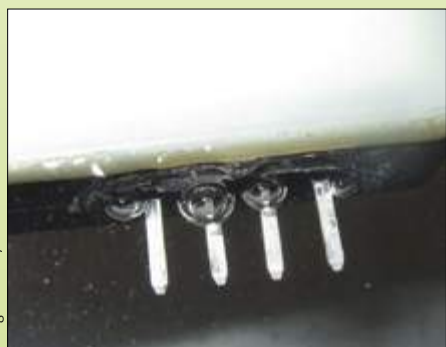
Fig. 1: Connecteur non étanche (bulles d'air). Test effectué sous l'eau avec pression interne de 0.5 bar.
